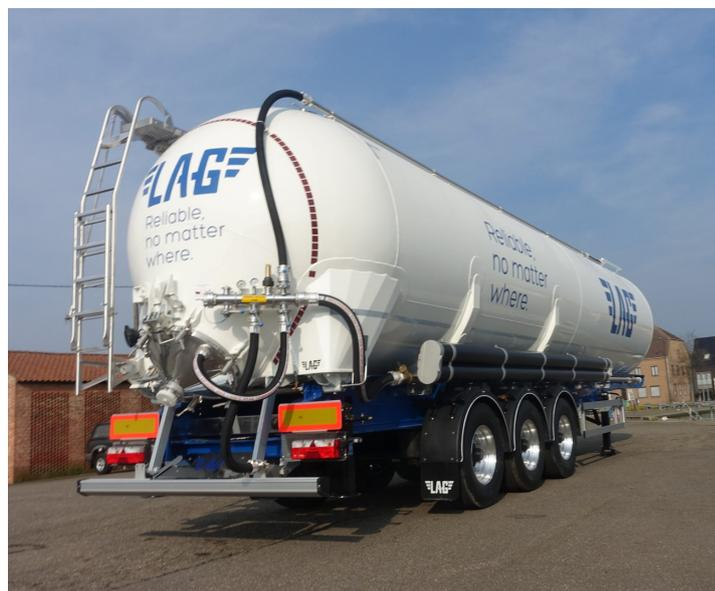
Il nuovo paraurti LAG, con vaschetta incorporata, ruota seguendo la cisterna in modo fluido e senza toccare terra, riducendo di molto le possibilità di rovinarlo durante lo scarico
